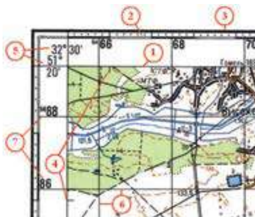
Мал. 40. Рамка і кілометрова сітка топографічної карти (1 : 100 000): 1 – внутрішня рамка карти; 2 – мінутна рамка; 3 – зовнішня рамка; 4 – виходи паралелей і меридіанів; 5 – значення широти і довготи кутів рамки; 6 – лінії кілометрової сітки; 7 – підписи кілометрової сітки
