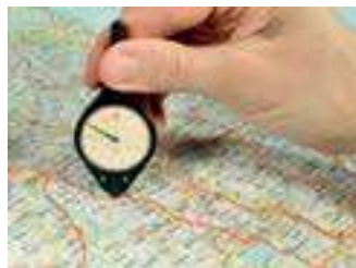
Мал. 46. Криві лінії на карті вимірюють за допомогою курвиметра
