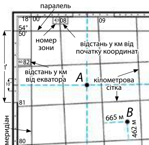
Мал. 40. Рамка і кілометрова сітка топографічної карти (1 : 100 000): 1 – внутрішня рамка карти; 2 – мінутна рамка; 3 – зовнішня рамка; 4 – виходи паралелей і меридіанів; 5 – значення широти і довготи кутів рамки; 6 – лінії кілометрової сітки; 7 – підписи кілометрової сітки
