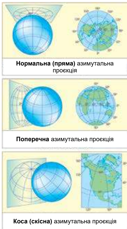
Мал. 35. Азимутальні проекції за орієнтуванням допоміжної поверхні
