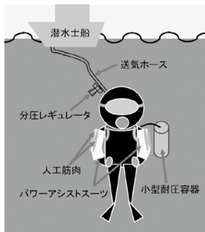
図5 海中でのパワーアシストスーツの概念図
