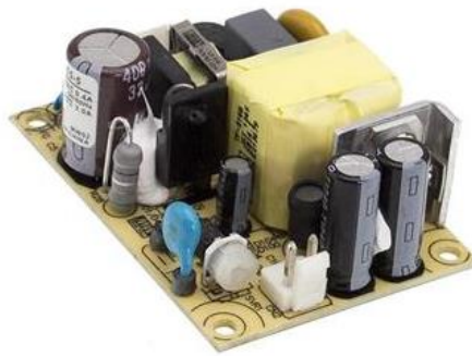
Рис. 4.6. Фото-ілюстрація блоку живлення відкритого типу EPS-15-12. [30]
