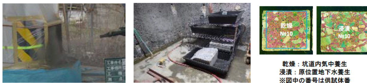
吹付けによる再現 実地下水を用いた暴露試験 中性化の進行度の例（約 1 年） 図 2B-34 異なる環境下で定置・養生した吹付けコンクリート供試体の各種試験結果の例
