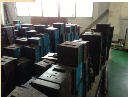
完成金型/保管
