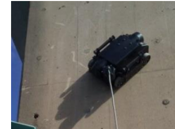
オンガエンジニアリング 天井・壁面を走行できる インフラ点検ロボット
