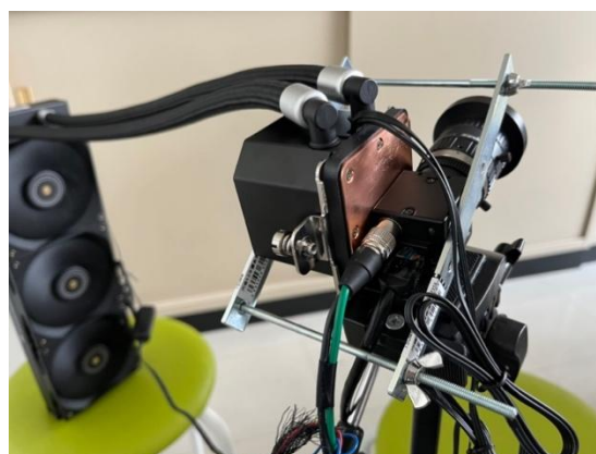
図 1: 観測装置の外観。カメラ本体を冷却するためのヒートシンクが、カメラに密着している。ヒートシンクで温められた液体は、ラジエーターで空冷される。
