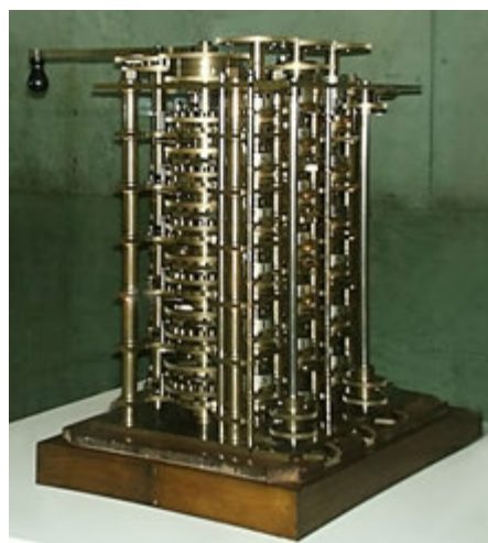
図11：1832年にバベッジによって製造された階差機関一号機のデモ用モデル(Science Museum, London) ※33 で7分の1モデルとも称されている ※10 。階差機関一号機の制作が長引くなか、周囲の理解を得るために急遽作られた5桁の数値を2次階差まで演算できる実演用デモ用モデル階差機関である。サイズは小さなテーブルに載せられるほどである。階差機関一号機のスペックは、20桁6次階差が予定されていた。当時はバベッジ家の居間に置かれ、現在はロンドン科学博物館に保存されている。現在でも動作可能であるとされている。また、東京理科大学の科学資料室に複製が置かれている。上野の国立科学博物館にも複製があるとされている ※30 。
