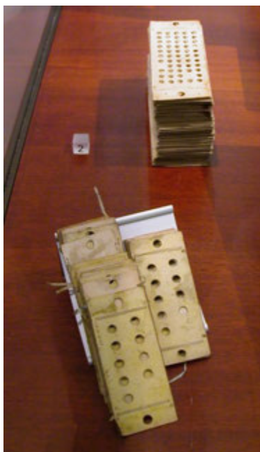
図19：解析機関のプログラム用のパンチカード ※41 解析機関のプログラム用の2種類のパンチカード。 手前：命令入力用の「演算カード」、奥：データ入力用の「可変カード」
