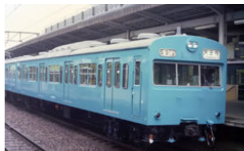
図17：国鉄103系電車 クハ103-149※39 1986年 和歌山駅 全長20m、全幅2.87m、全高3.935m
