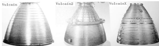
图 3 Vulcain 系列发动机的喷管延伸段
