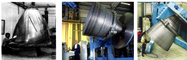
图 2 制造中的“火神”1/“火神”2 螺旋管束式喷管
