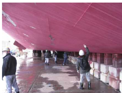
旅客フェリーの船底を検査する船舶検査官
