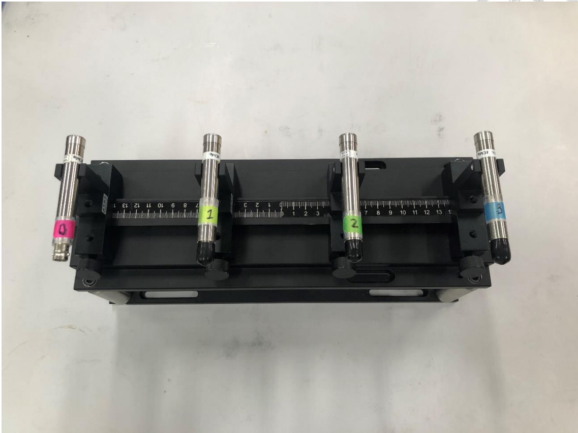
圖 3 - 16 麥克風陣列照片 ( M = 4 , d = 0.1m )
