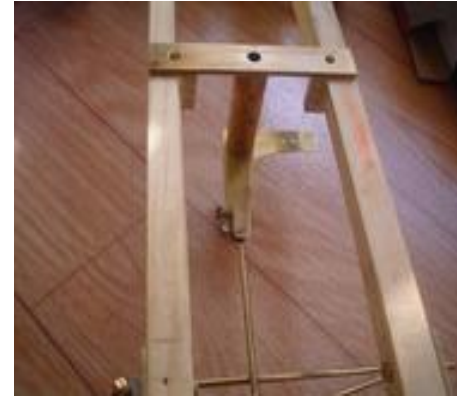
Montage et essais. Le plat pourra, par la suite être vissé sur le châssis en bois.
