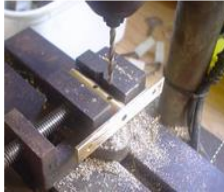
Perçage : la barre supérieure permet de bien percer dans l'axe du rond.
