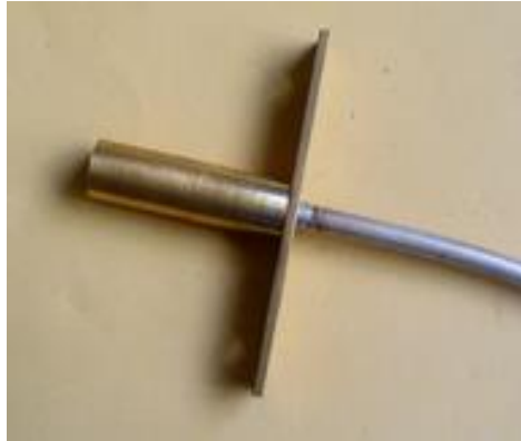
Soudure à l'étain : rond d'aluminium pour maintenir les deux pièces dans l'axe.
