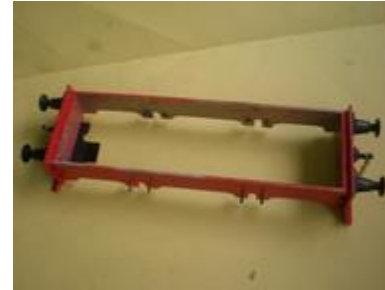
montage des côtés du châssis
