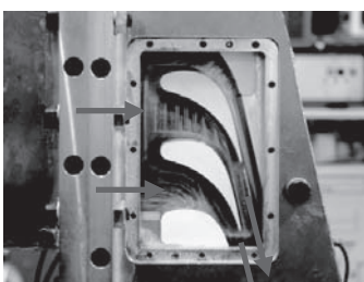
図6 翼列風洞試験
