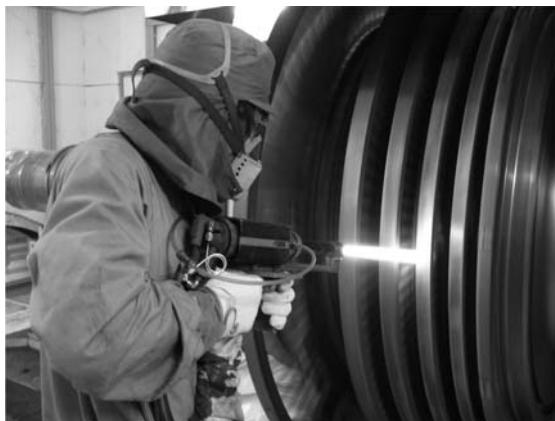
図11 ロータへのHVOFコーティング実施例
