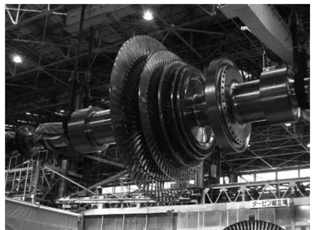
(b) 1800rpm-74IN 最終翼群の0.5スケール実負荷試験ロータ
