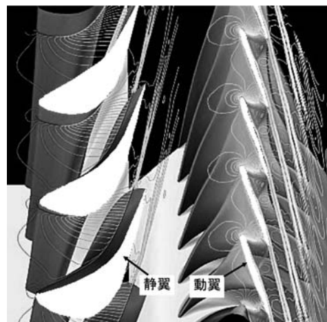
図3 静動翼3次元湿り乱流解析例
