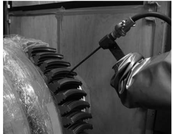
図12 ロボットによるショットピーニング実施例
