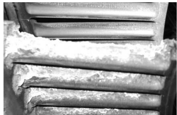
図13 静翼へのスケール付着の例
