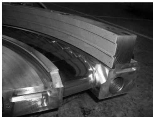
図11 アプレイダブルシールの例 (5)
