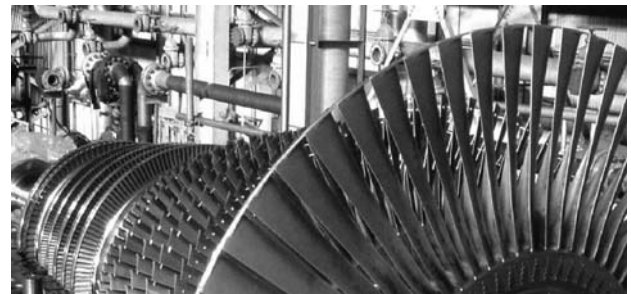
写真3 661動翼組立 (最終段)
