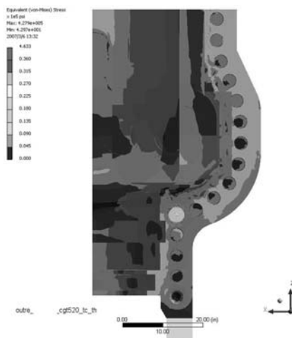
図6 外ケーシング水平断面の応力分布 (1.5時間後)
