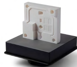
Rigid 10Kレジンをを使って、静止側をビルドプラットフォームに向けた状態でプリントした型。
