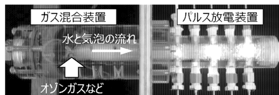
図6 オゾン気泡を含むパルス放電装置。
