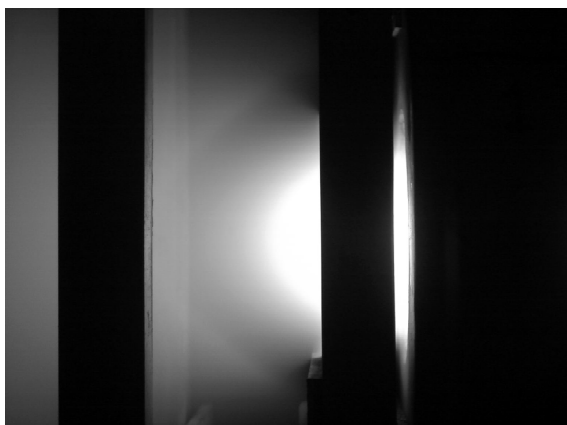
Fig. 2 希薄気体風洞内の磁気チャネルから噴出するヘリウムアークジェット（右から左に流れる）。
