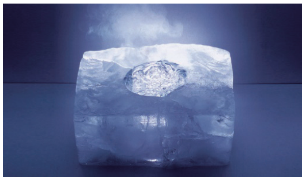
図2. 氷の塊中で水が蒸発する様子 写真は氷の塊中で水が蒸発する様子をしたもの。 ( http://www.pueschner.com/ ) 2) Selective 3D-Microwave Heating of Water within an Ice Cube
