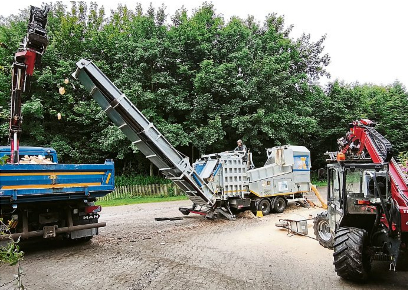
Im Einsatz für ofenfertiges Brennholz: Moderne Technik verarbeitet auch große Stämme direkt vor Ort.
