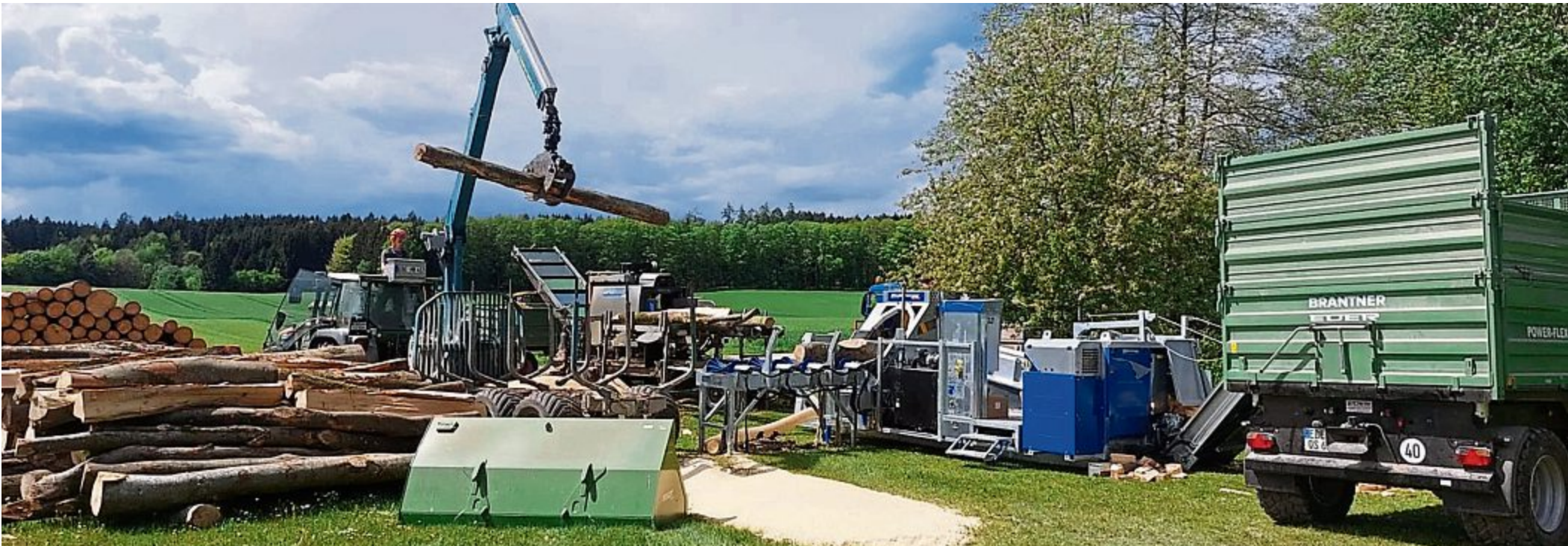
Die neue Binderberger SSP 800 spaltet Stammstücke bis zu 80 cm Durchmesser – mobil und effizient beim Kunden.
