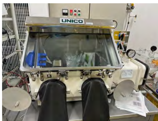
図4. 従来空気中で形成していたため、湿度や窒素 などの空気中混合物の影響が不明であった。この対 策として、グローブボックスを導入して、成膜環境の 制御を行っている。
