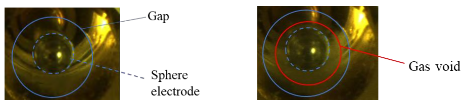
図 2. 油ギャップ内観察画像（右側：ボイド発生前、左側：ボイド発生後）
