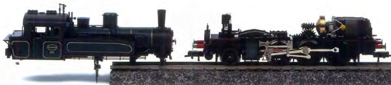
De bovenbouw is makkelijk te verwijderen. De aandrijving met wormwiel is duidelijk te zien.
