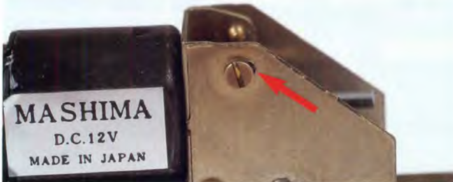
De motor mag "zwevend" opgehangen worden om 'm juist te fixeren voor je 'm vastschroeft. Daartoe mogen de ophangpunten lichtjes uitgevild worden.
