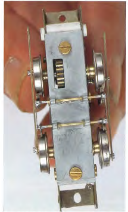
Zorg ervoor dat de remklauwen de drijfstan- gen niet hinderen.
