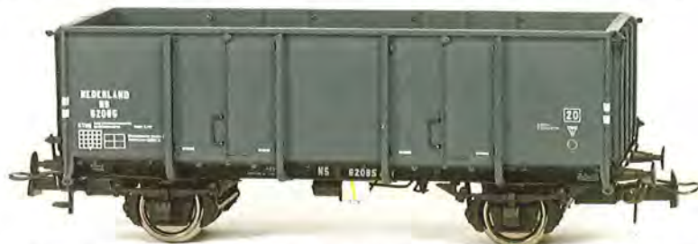
De NS GTMK 62085 met korfbuffers, glijlagers en Kunze-Knorr remwerk met traditionele opschriften, periode 1938-1945.
