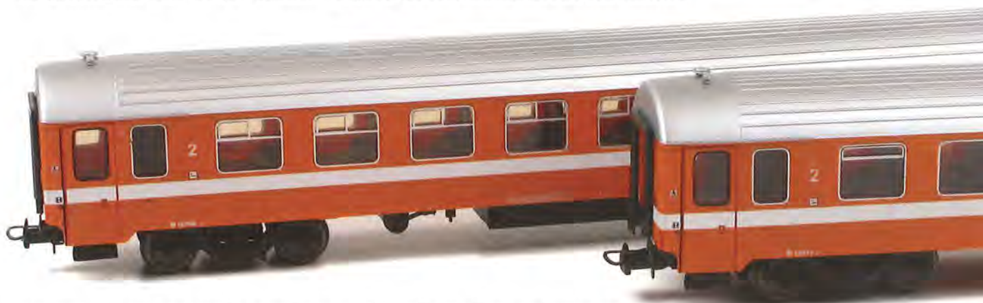
Achteraan zie je een rijtuig zonder airconditioning met verluchttingsraampjes, op de voorgrond een geklimatiseerd rijtuig met overwegend gesloten ramen.
