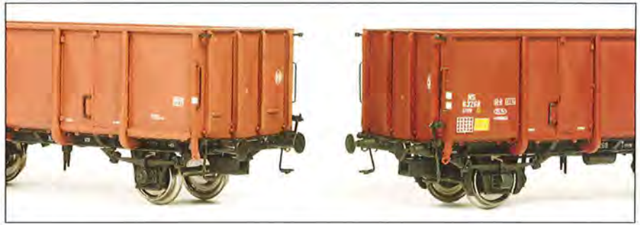
Links een GTU met rollagers, hulsbuffers en versterkingsprofielen onderaan de uiteinden van de zijwanden. Rechts een GTUW met glijlagers en korbuffers.
