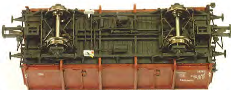
De wagens zijn aan de onderzijde vergaand gedetailleerd. Het kortkoppelmechaniek is met twee schroefjes bevestigd, dus gemakkelijk te verwijderen.
