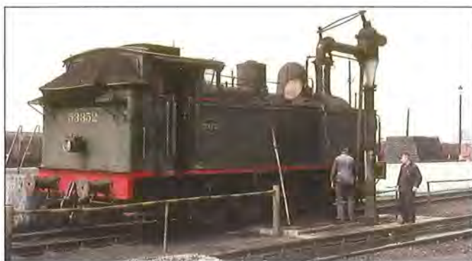
Loc 53.352 van de stelplaats Hasselt. Water- en kolenvoorraad zijn aangevuld. Klaar voor volgende inzet. Foto Max Delie
