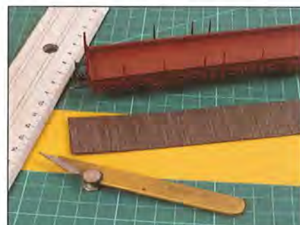
De dubbelzijdige tape – zoals gebruikt voor het vastkleven van vloerbedekking – wordt op maat gesneden.
