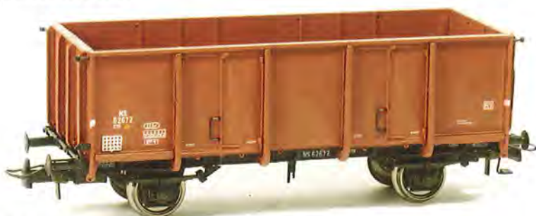
GTU 62672, een onberemde wagon met rollagers en hulsbuffers.
