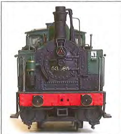
Frontaal aanzicht van de nieuwe realisatie van TGO. Rangeerhandgrepen en installatie van de rookdemper zijn duidelijk merkbaar.
