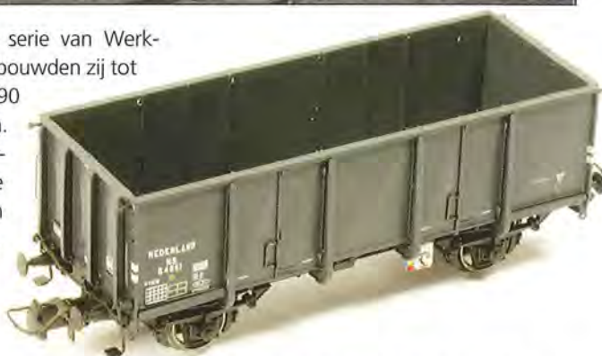
GTMW 64561 met Korfbuffers, rollagers, Westinghouse remwerk en vereenvoudigd opschrift periode 1940-1950.
