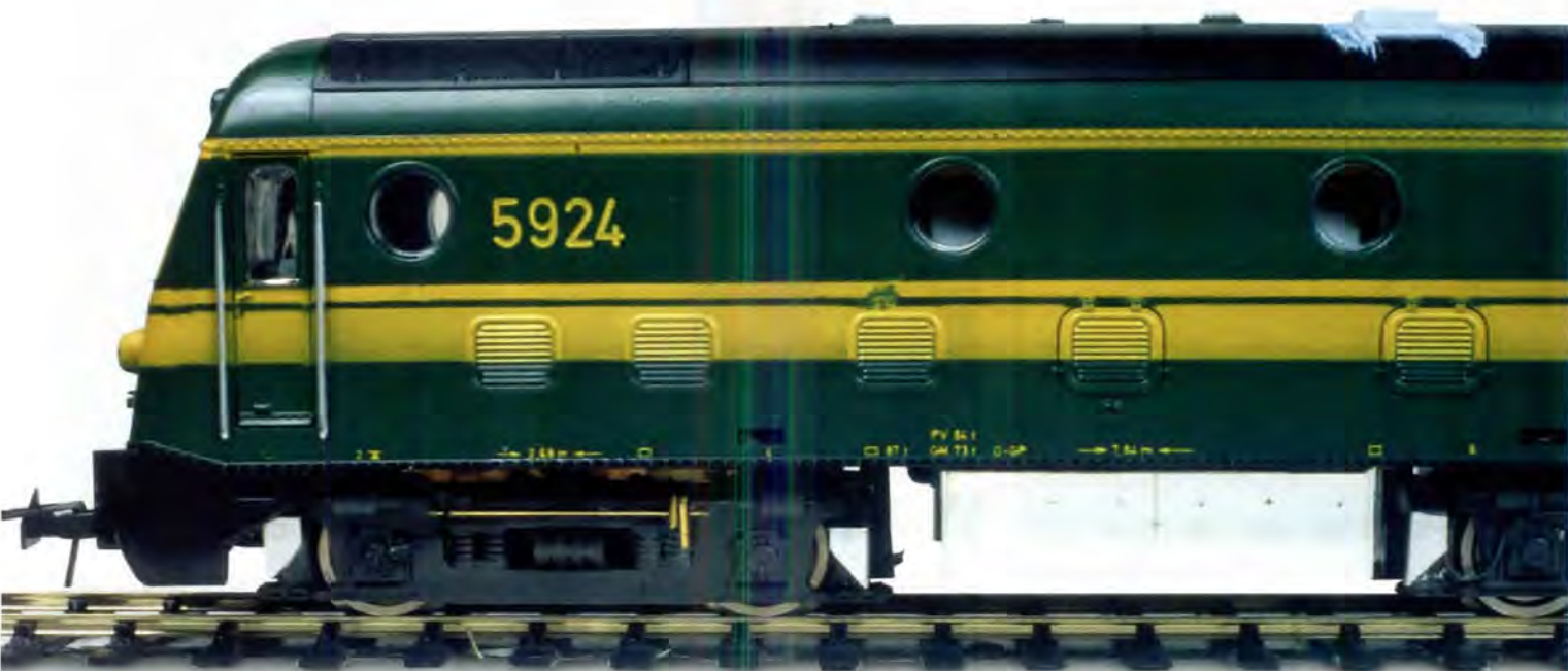
Zijaanzicht van model in aanbouw, alle bijkomende onderdelen zijn in wit plasticard.
