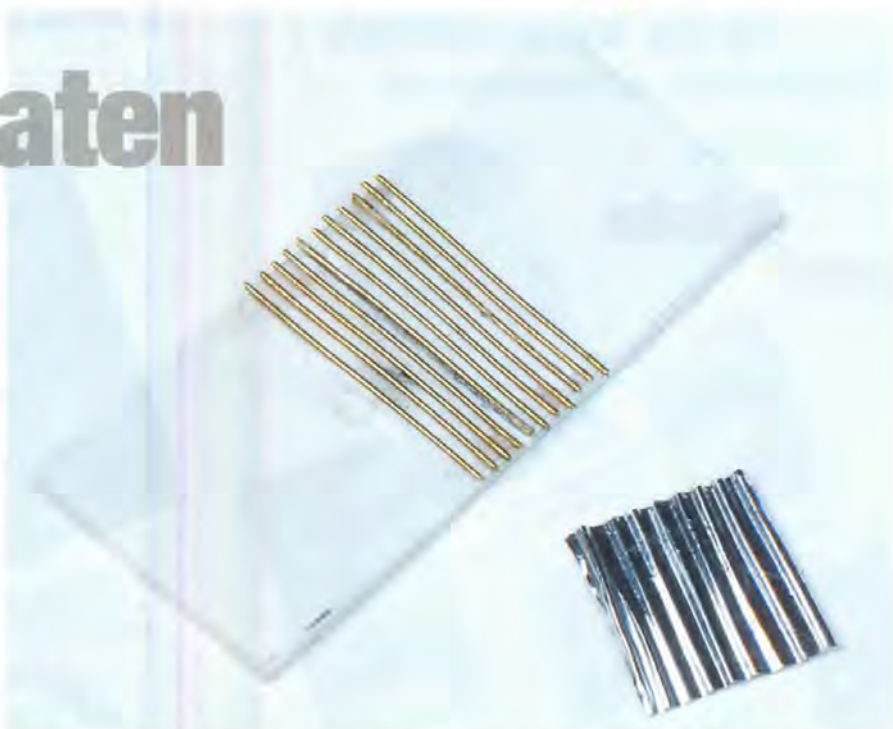
Door twee zo 'n profielen op elkaar te drukken met een stukje industriële aluminiumfolie ertussen verkrijg je een mooi stukje golfplaat.
