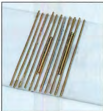
Hier zie je duidelijk hoe de staafjes van 0,75 mm diameter en 15 mm lengte worden gebruikt om de afstand tussen de staafjes van 0,5 mm te bepalen.
