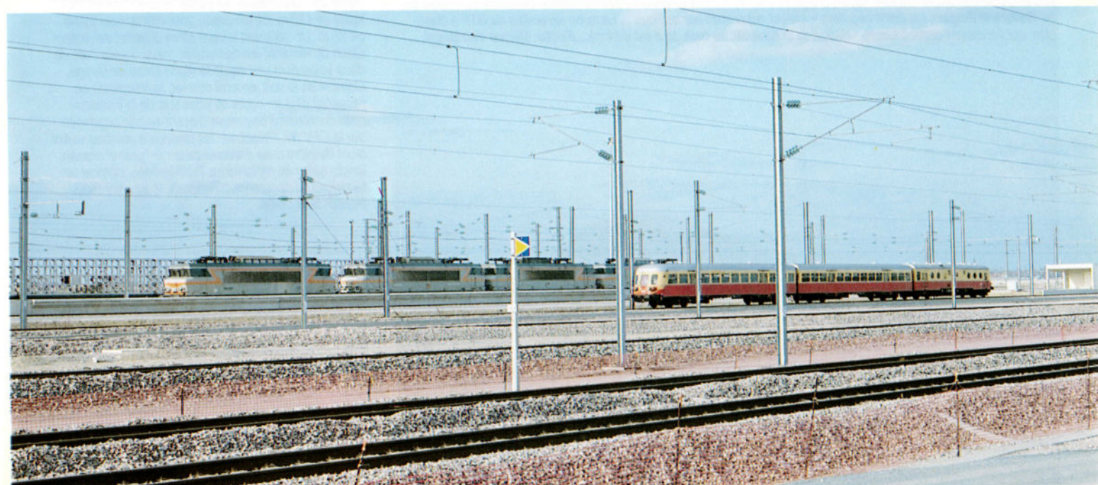
11. Pour pallier le retard apporté à la fourniture des nouvelles locomotives destinées aux trains marchandises dans le Tunnel sous la Manche, des BB 22 200 de la SNCF ont été équipées afin de pouvoir y circuler sans encombre et assurer ainsi l'intérim. Quatre d'entre-elles sont visibles ici, voisinant le... 4001 du Chemin de fer des Trois Vallées qui assure des navettes de service entre la surface et le Tunnel, pour le compte des CFTA. Outre ces engins, des autorails "Picasso" des CFTA circulent également sur ce site! Coquelles (F), le 26 mars 1993. Photo: Olivier Geerinck.
