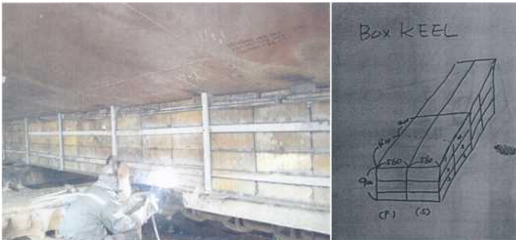
[그림 6] 선저부분 박스킬 설치
