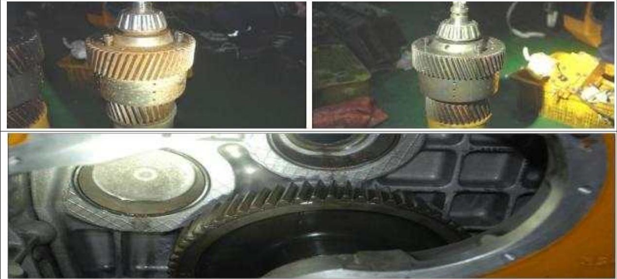
<그림 13> 클러치 전진 기어(위 좌), 후진기어(위 우), 기어박스 내 기어(아래)
