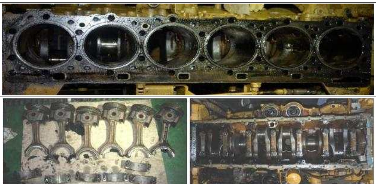
<그림 12> 엔진 실린더(위), 피스톤, 커넥팅 로드, 베어링(아래 좌) 및 크랭크 축(아래 우)
