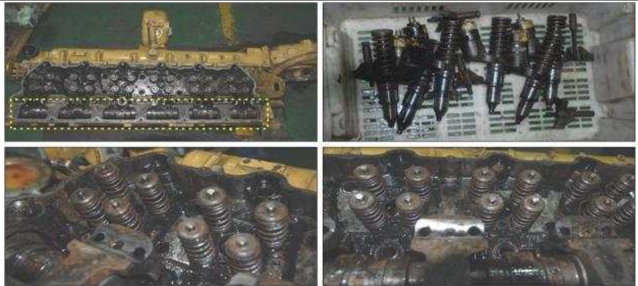
<그림 11> 엔진의 캠축(위 좌), 인젝터(위 우), 흡배기 스프링(아래 좌·우)
