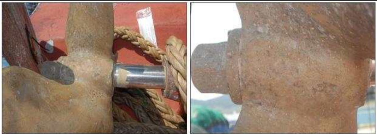
<그림 20> 신양항에 양륙된 돌고래호의 스크류 및 스크류 샤프트
