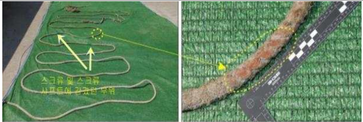
<그림 19> 돌고래호에서 수거된 로프 및 적갈색 페인트 부착 부위
