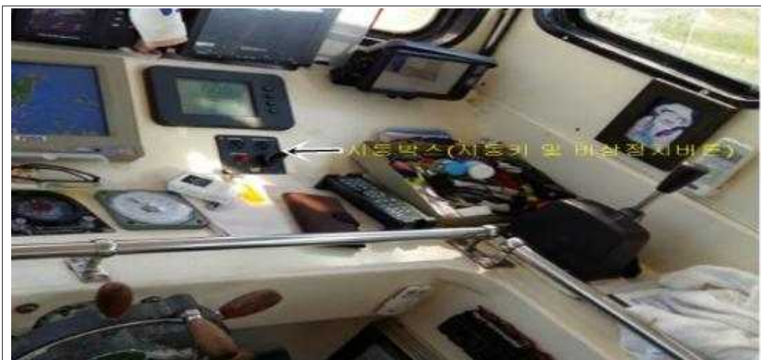
<그림 26> 돌고래호 엔진과 동형의 엔진이 탑재된 어선의 시동박스
