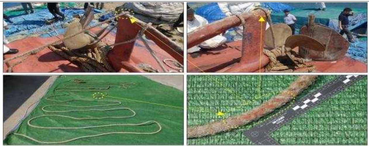
<그림 22> 진회색 로프에 압착된 적갈색 페인트의 위치 및 회전 시험
