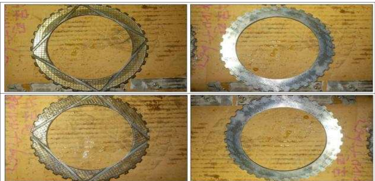
<그림 14> 전진기어(위 좌·우) 및 후진기어(아래 좌·우)에 삽입된 마찰판 및 스틸플레이트
