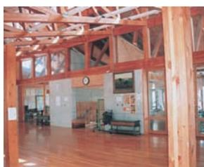
外周架構をRC造として自立させ、内部支柱と屋根架構を木造とする計画で、最も多く見られる混合構造の形式である。これは台風対策やシロアリなどに対する維持管理の面から採用されている。
