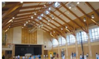
ステージ、玄関、更衣室などをRC架構として両端部に配置し、長手方向に扁平な曲線の梁を架けている。曲線梁の端部に生じるスラストは全てRC架構で処理される。
