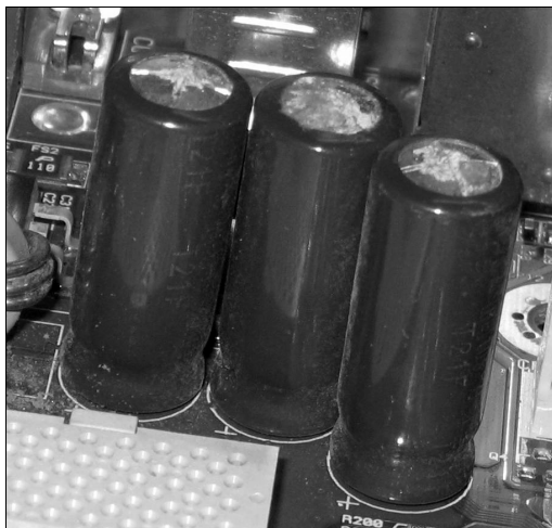
Рис. П1.2. Вздутые конденсаторы со следами коррозии на крышке
