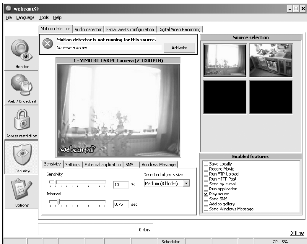
Рис. 7.32. Настройка детектора движения
