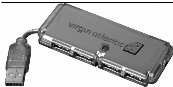
Рис. 7.8. Разветвитель USB на четыре порта с разъемом для внешнего питания
