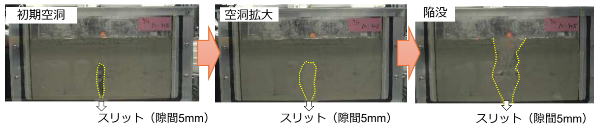
空洞の形成、陥没の状況（ケース1）
