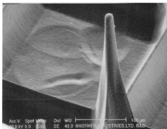
図 4.7 パターン No.2 の PLLA 成形品の SEM 写真
