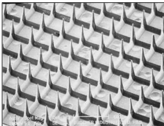
図 4.7 パターン No.2 の PLLA 成形品の SEM 写真
