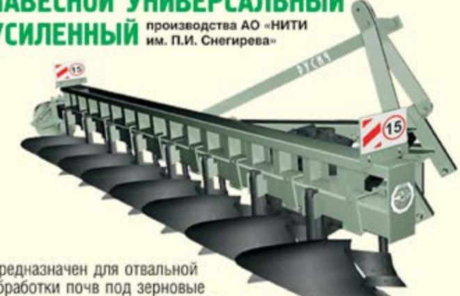
Предназначен для отвальной обработки почв под зерновые и технические культуры на глубину до тридцати сантиметров на почвах, не засоренных камнями, плитняком и другими препятствиями.
