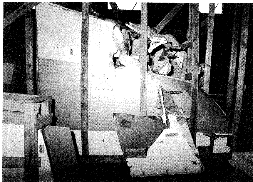
写真－ 62 右側水平尾翼々端部の損壊状況
