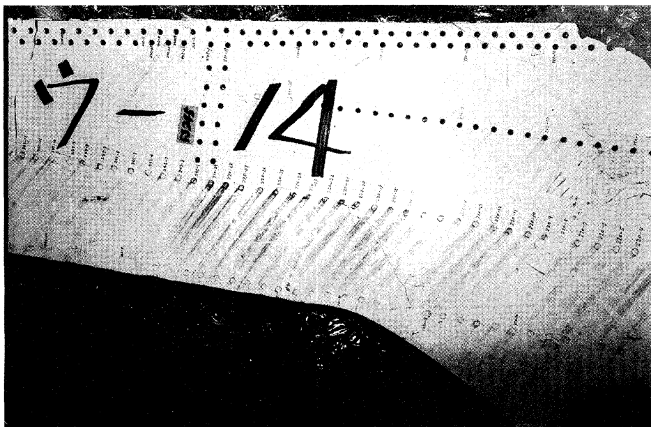
写真－ 58 垂直尾翼右側外板の黒色付着物(1)
