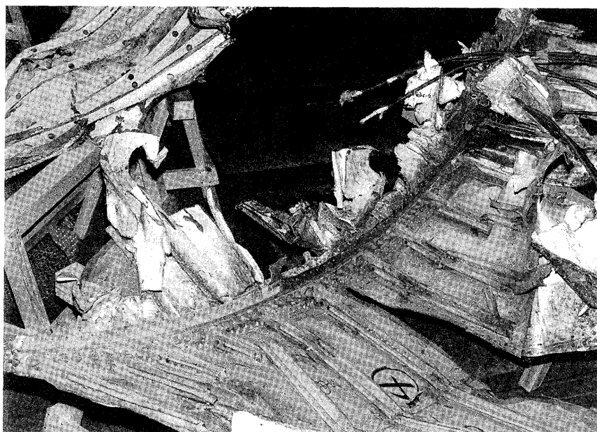
写真－ 72 後部圧力隔壁パート4(与圧側)
