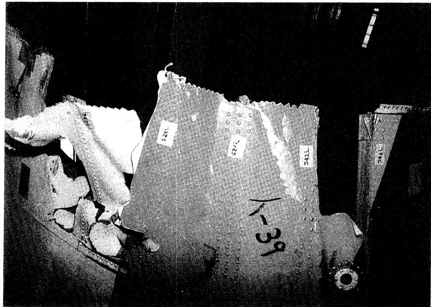
写真 - 41 BS2658APU防火壁取付部 26L付近の破断状況
