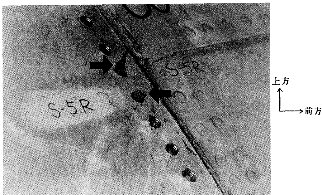
写真- 43 BS2638胴体外板のファスナ孔より 吹き出したとみられる断熱材
