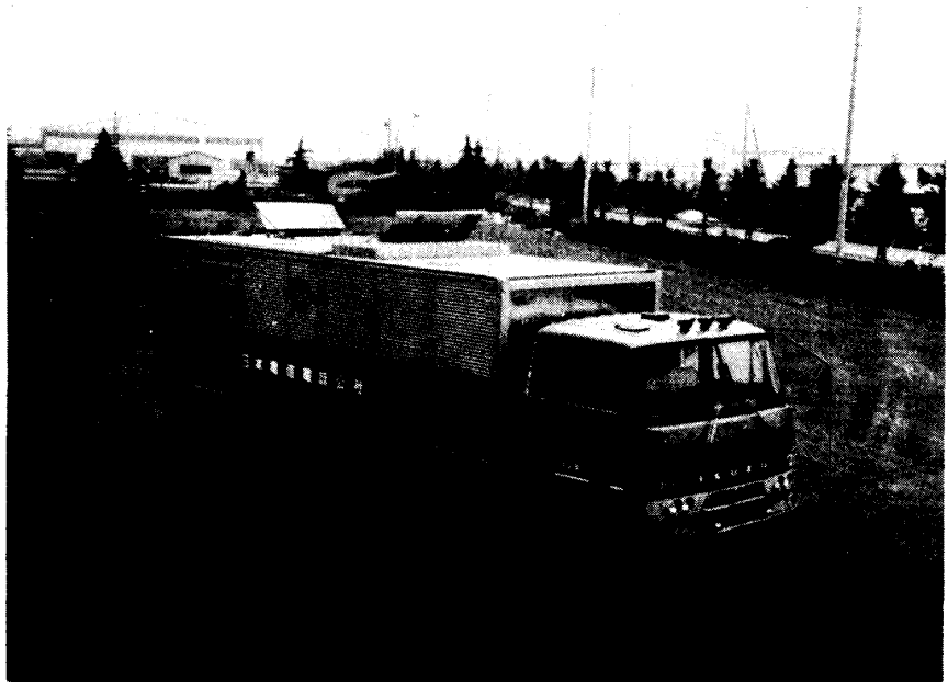
写真2 1,000kVA移動電源車
