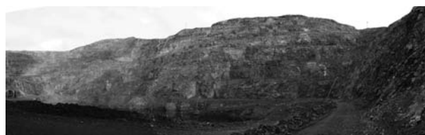
図5 米国カリフォルニア州、マウンテンパス鉱山の露天採掘場。1990年代の主力レアアース鉱山であり、一時休山していたが、2011年から生産を再開した。左側の明色部がカーボナタイト岩脈。
