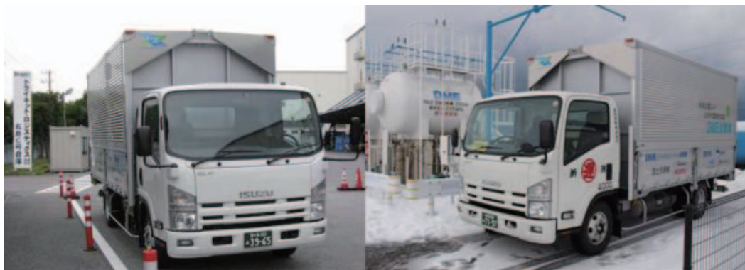
図2 実証営業走行試験中のいすゞ中央研究所製3.5t積載ウィングバンDMEトラック
