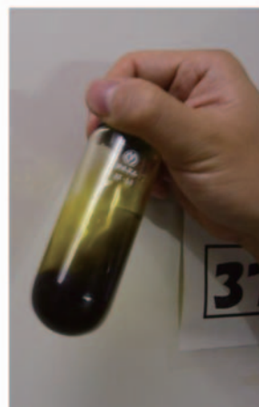
図12 微細藻類から抽出したバイオ燃料 (a) 藻に圧力を加え油が染み出した様子（倍率×400） (b) 微細藻類から抽出した燃料成分
