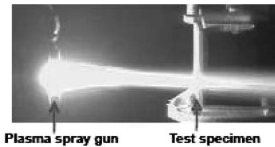
図23 TBC試作材のプラズマ溶射状況
