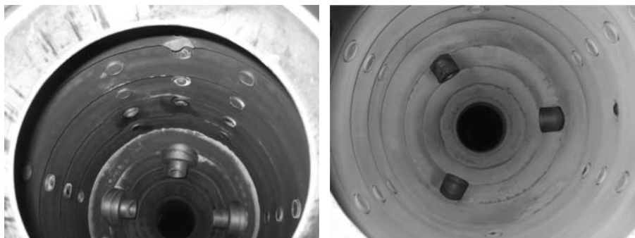
図9 燃焼器ライナ状況 (左: 冷却構造改良前, 右: 改良後)
