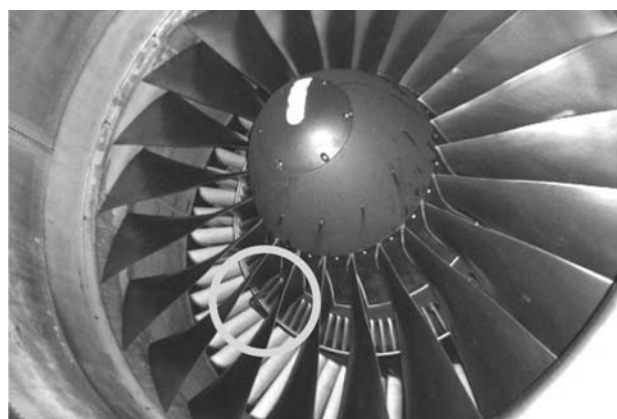
図5 取り付けられた洗浄Probe (エンジン前方より)
