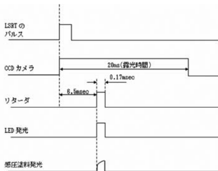
図15 撮影時のディレイ回路による制御
