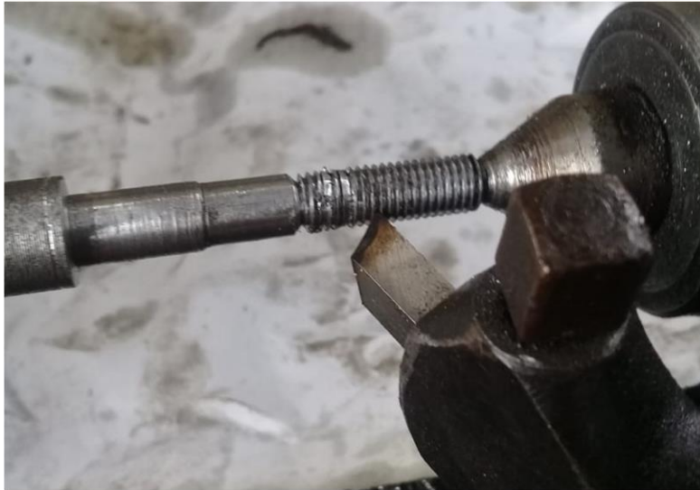
Figura 46 Maquinado de la rosca izquierda del eje (caso de estudio).
