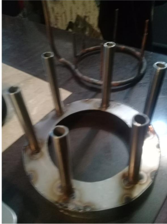
Figura 35 Maquinado, armado y soldado de las lunbreras de la cámara de combustión (caso de estudio).
