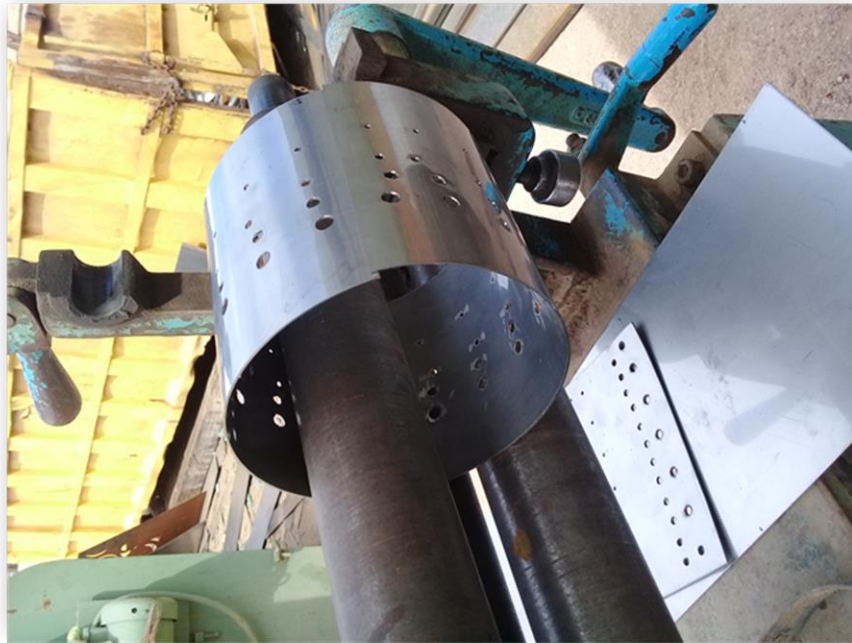
Figura 32 Rolado de la cámara de combustión (caso de estudio).
