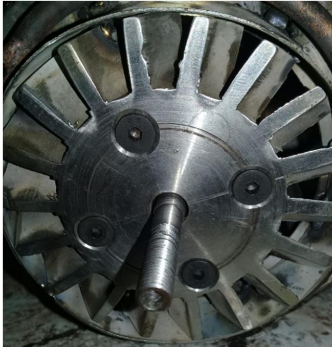
Figura 37 Ensamble del difusor de la turbina en la cámara de combustión (caso de estudio).
