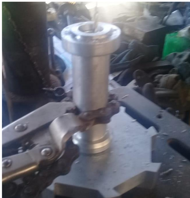
Figura 47 Maquinado de la manga del eje de la turbina (caso de estudio).
