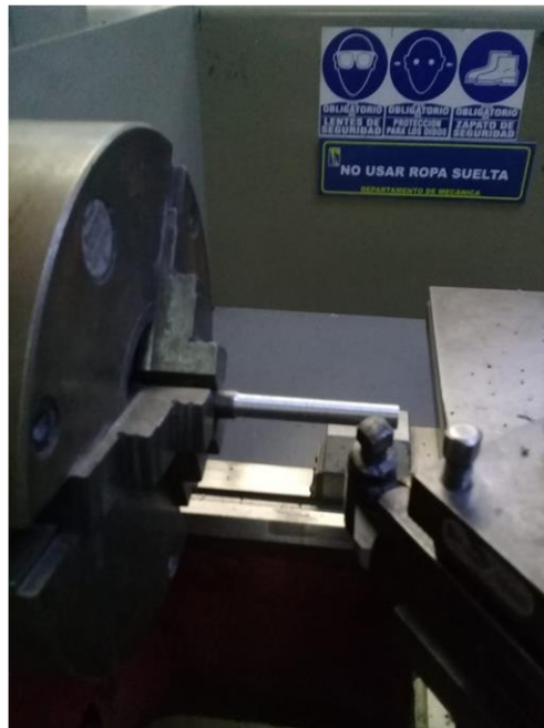
Figura 45 Maquinado del eje de la turbina (caso de estudio).
