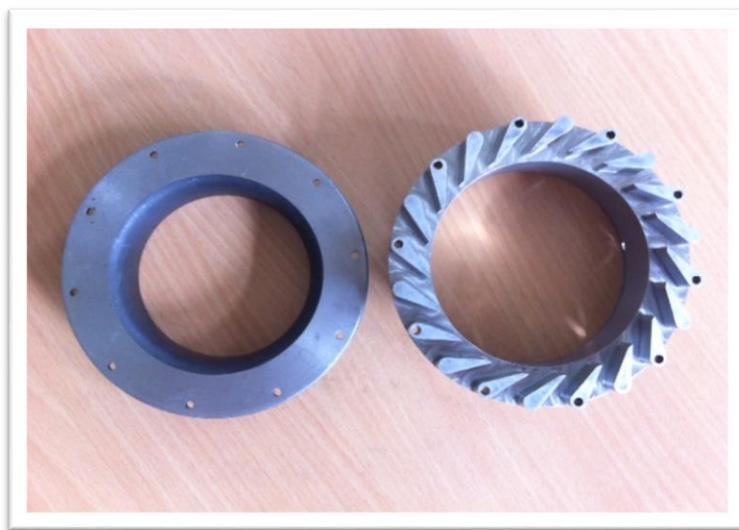
Bild 16. Turbinhus med utfrästa ledskenor
