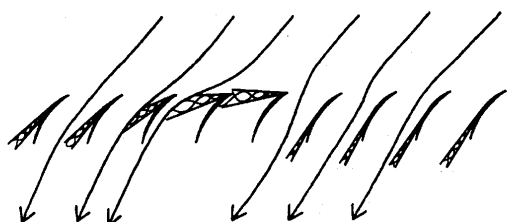
(b) Tip Leakage Vortex による伝播の開始モデル
