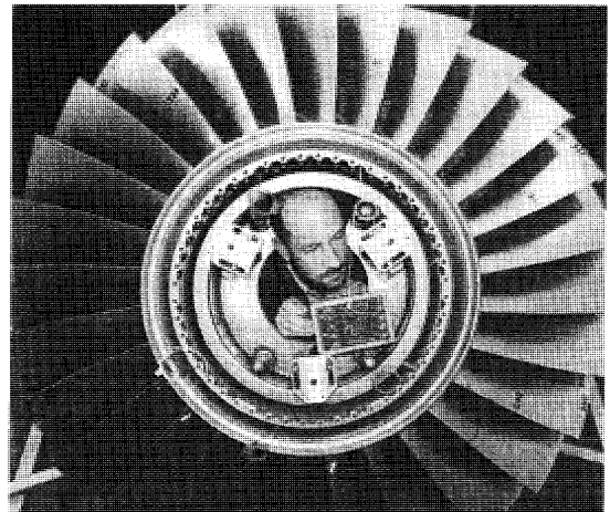
図5 Rolls-Royce 社リフトファンのチタン製ブリス (6)
