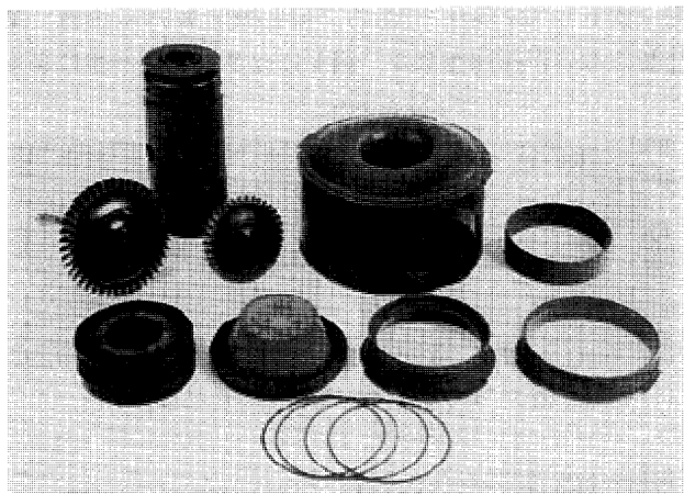
図3 CGT 302 のセラミック部品
