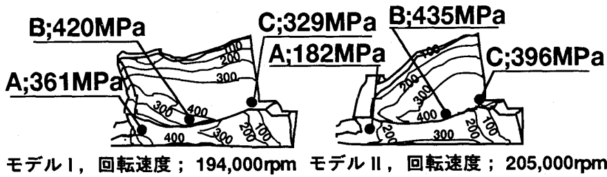
図 12 平均破壊回転速度での応力分布
