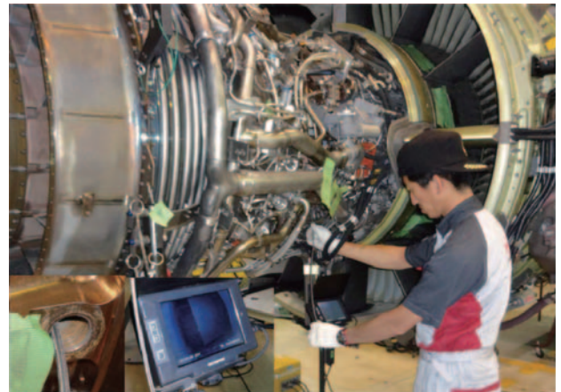
Fig.4 ボアスコープ ケーブルの挿入状況
