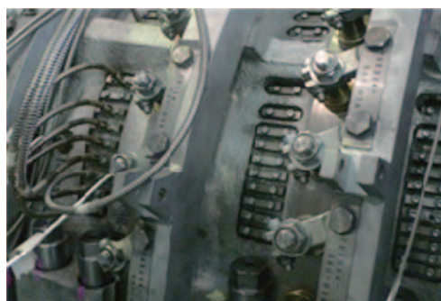
図18 光学式チップタイミング振動計測の例
