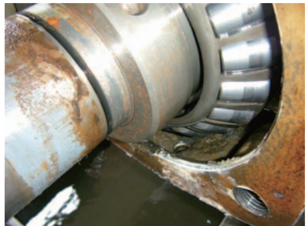
主ポンプ外軸受内部の砂除去前
