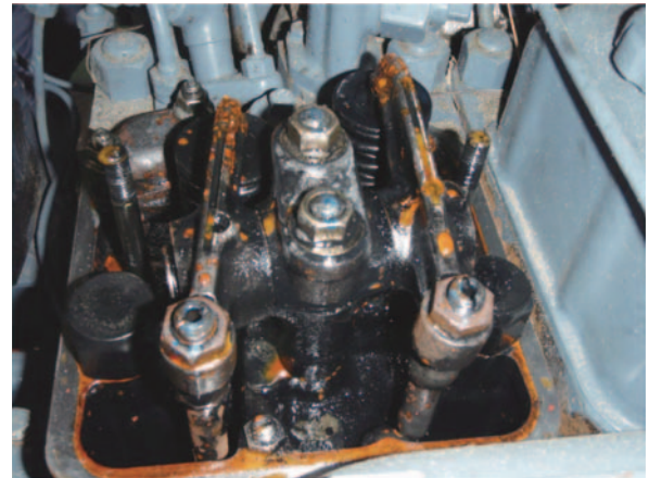
エンジンシリンダヘッド内部の発錆状況
