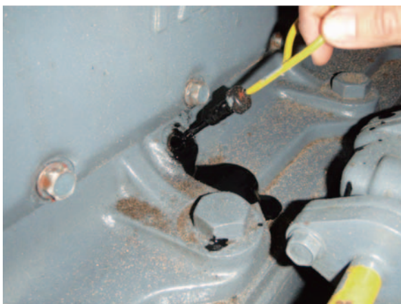
機関内に海水侵入したため給油口からオイル漏れ
