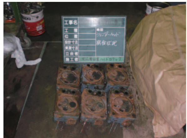
シリンダヘッド発錆状況（被災後約2ヶ月）
