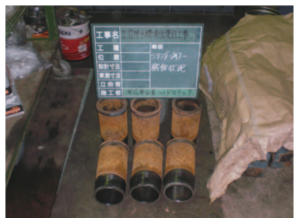
シリンダライナ発錆状況（被災後約2ヶ月）
