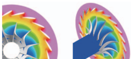
Fig. 4 タービンのCFD解析結果 (一例)
